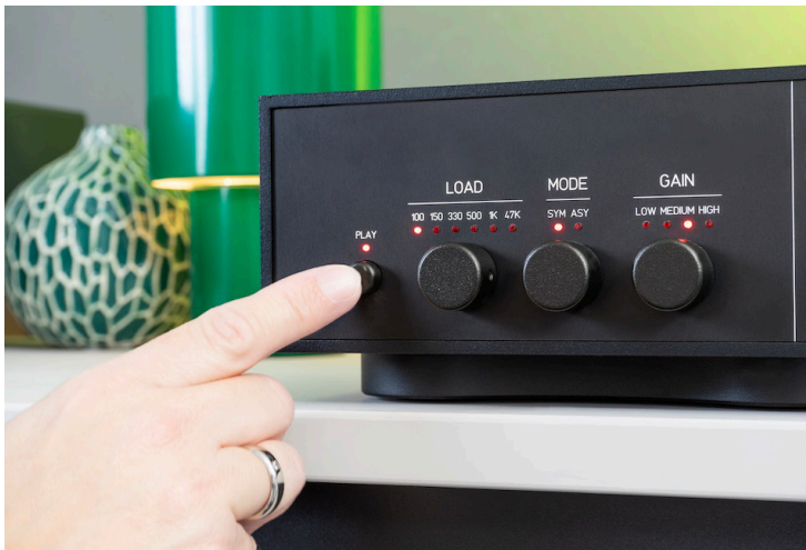
Der „Play“-Schalter dient der Stumm-Schaltung. Seine Nutzung empfiehlt sich beim Betätigen der Wahlschalter, um Umschaltgeräusche zu vermeiden. Auch nach Einschalten der Vinyl-Engine ist das Drücken des „Play“-Schalters erforderlich, um die Verstärker-gänge freizuschalten.
